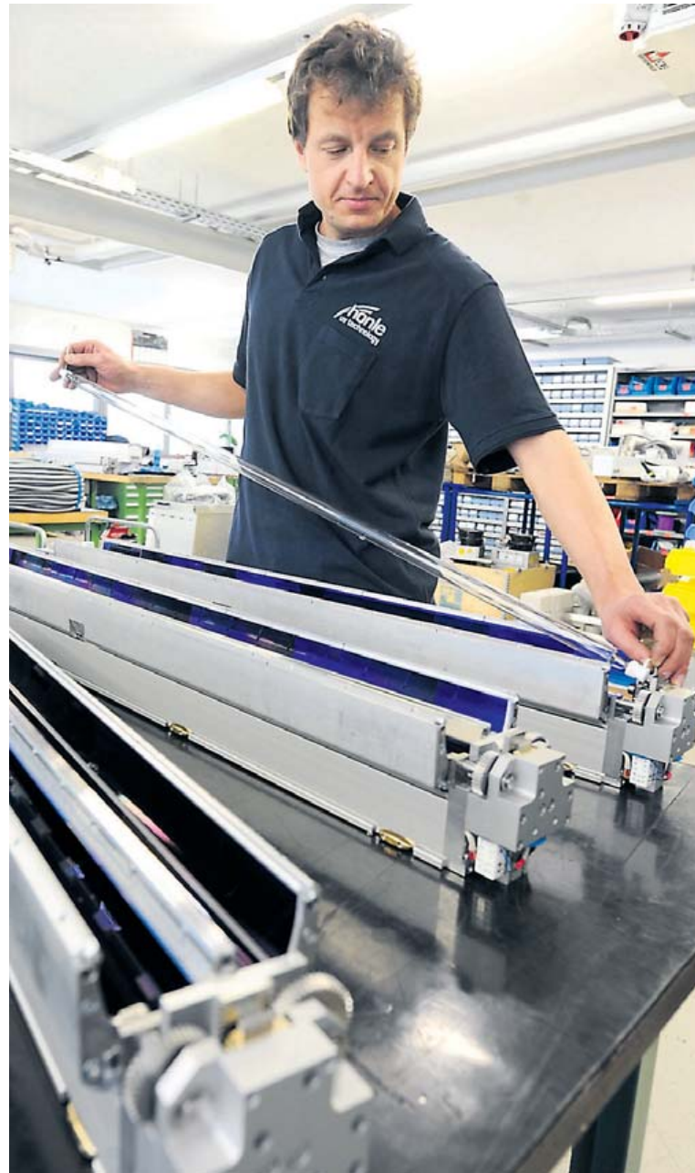
Die Kaltlichtreflektoren, die im Gräfelfinger Werk der Hönle AG entstehen, werden später in Druckmaschinen zur Farbtrocknung eingesetzt. Foto: Rumpf
