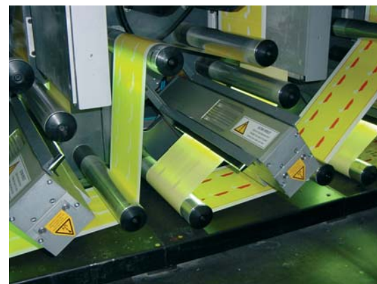
Zwei UV-Trocknungseinheiten von Dr. Hönle in einer Flexo-Druckmaschine.
