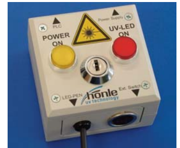
Steuereinheit des UV-Pens
