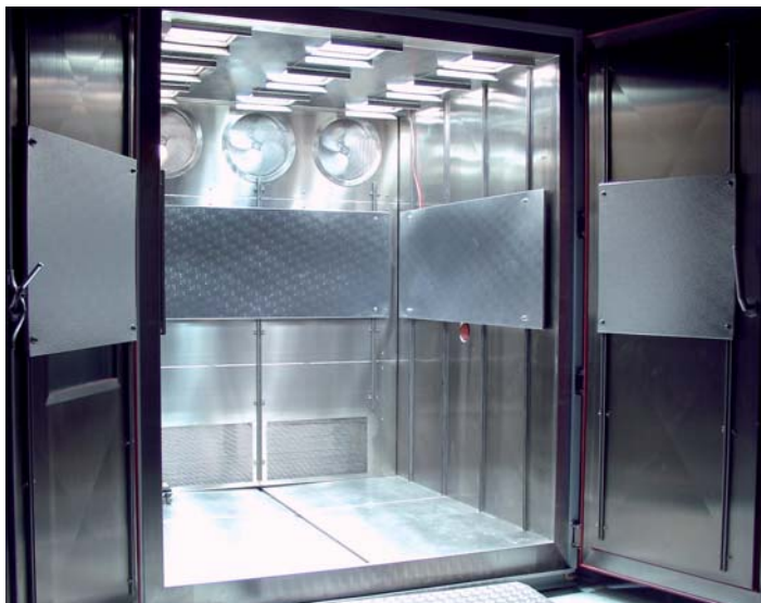
Klimakammer mit 9 SOL 2000 Geräten
