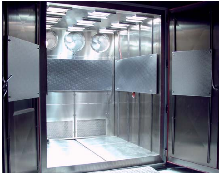
Klimakammer mit 9 SOL 2000 Geräten
