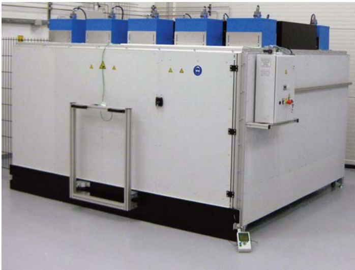
Irradiation chamber 2,2 m x 2,6 m
