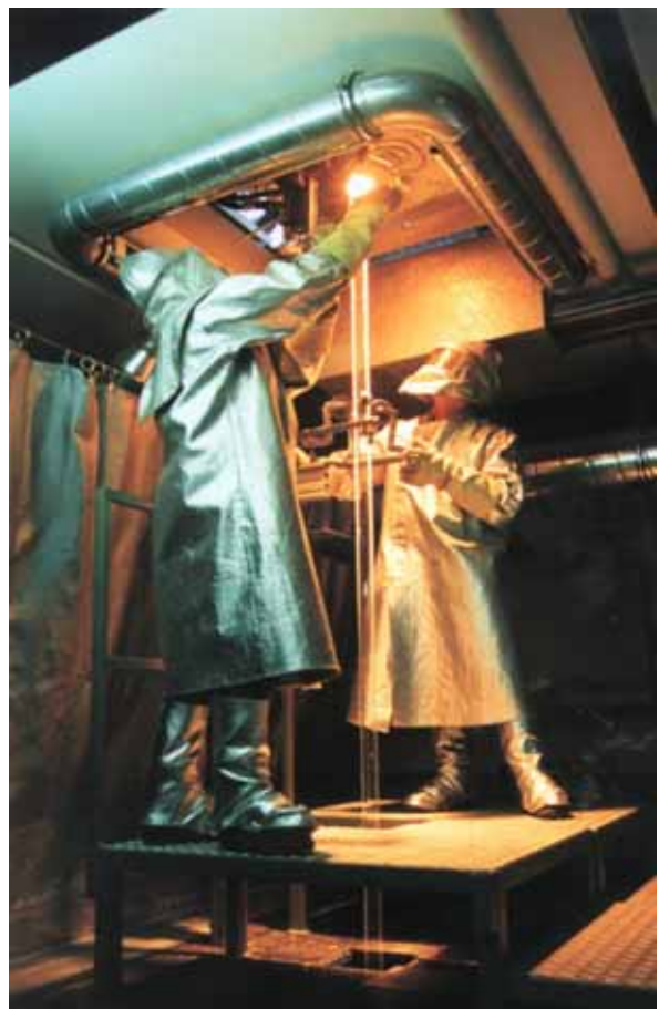
Herstellung von Quarzglasrohren bei Raesch Deutschland
