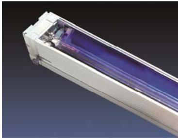
Die Vorteile dieser gelungenen Produktweiterentwicklung beruhen auf der Verschmelzung der patentierten *pureUV*-Technologie mit der des *LightGuide*, wobei die bislang wassergekühlte Barriere durch einen Quarzglasrohr ersetzt wurde. Dadurch erreicht das Strahlerteil im Peak gut 50% mehr UV-Intensität, die Trocknungsleistung wird um 10% erhöht – und das bei einem um 15% geringeren Temperatureintrag.
