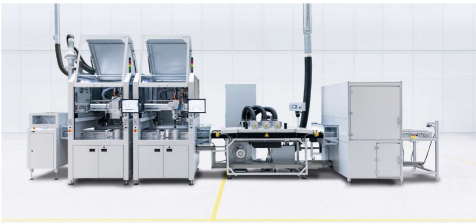
Dosieranlage zum Abdichten von Zellmodul-Controllern im CIPG-Verfahren
